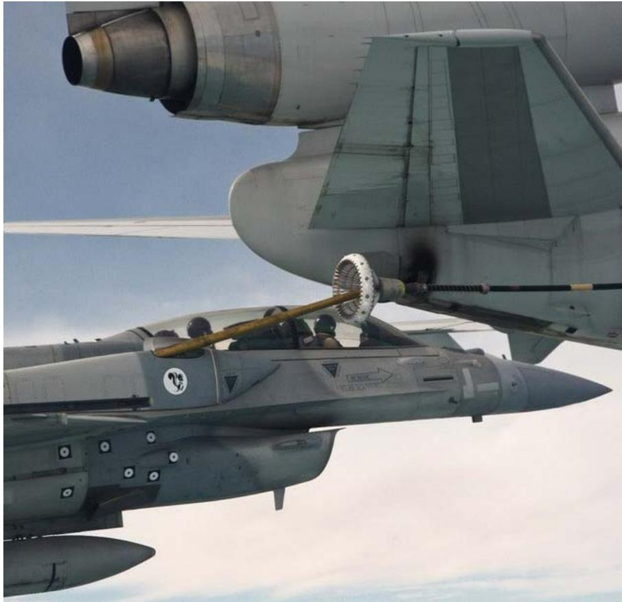
圖 5：F-16IN 戰機機背適形油箱加裝空中加油管
