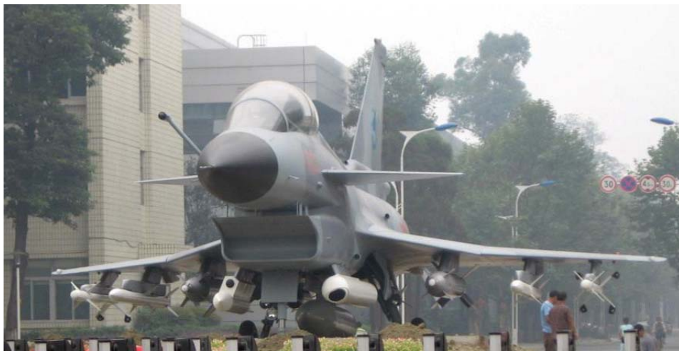
圖 6. 殲-10 雙座機機身搭載紅外線搜索吊艙[4]
