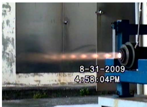
圖 11、大通道混合火箭及測試時照片[41]
