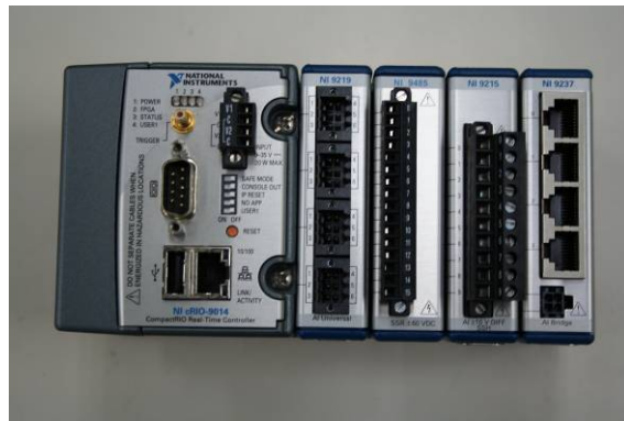
圖 2.2-1 訊號擷取與控制系統之 CompactRIO 模組
